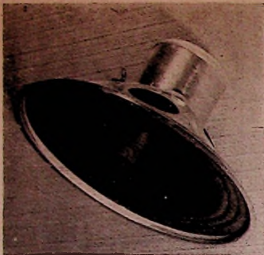
Aanzicht van een dubbelconus luidspreker
